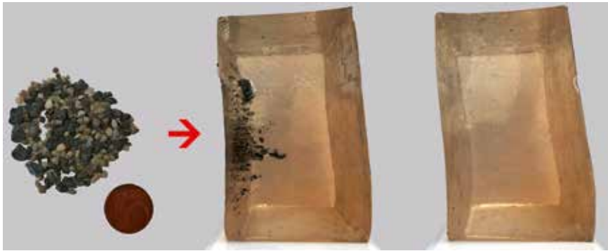
Sandkanonenbeschuss auf Gelatineblock (TNO, Niederlande); links: eingeseetzte Sekundärsplitter wie Sandpartikel, Staub, Schmutz und Geröll (1-6 mm), Mitte: Gelatineblock nach Beschuss ohne Schutzlage BALUW, rechts: Gelatineblock nach Beschuss mit Schutzlage BALUW
